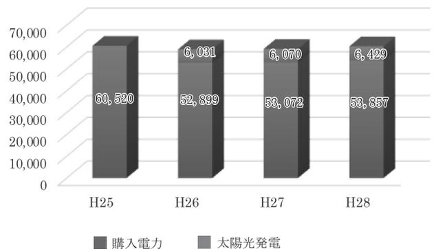
藤里小学校の電気使用状況は、平成25年度に比べ、平成26年度7,621kwh、平成27年度7,448kwh、平成28年度6,663kwh減少しています。これは、太陽光で6,031kwh、6,070kwh、6,429kwh発電されたことで、減少したものと分析されます。
