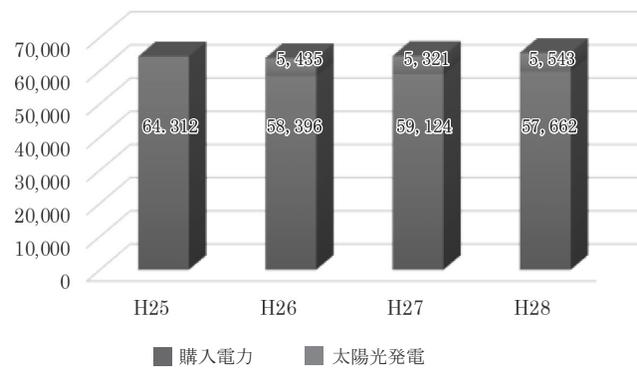
藤里中学校の電気使用状況は、平成25年度に比べ、平成26年度は5,916kwh、平成27年度は5,188kwh、平成28年度は6,650kwh減少しています。これは、太陽光で5,435kwh、5,321kwh、5,543kwh発電されたことで、減少したものと分析されます。
