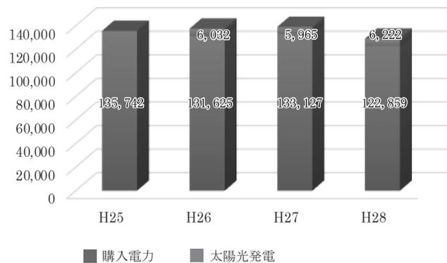
三世代交流館の電気使用状況は、平成25年度に比べ、平成26年度4,117kwh、平成27年度は2,615kwh減少しています。これは、太陽光で、6,032kwh、5,965kwh発電されたことで、減少したものと分析されます。
