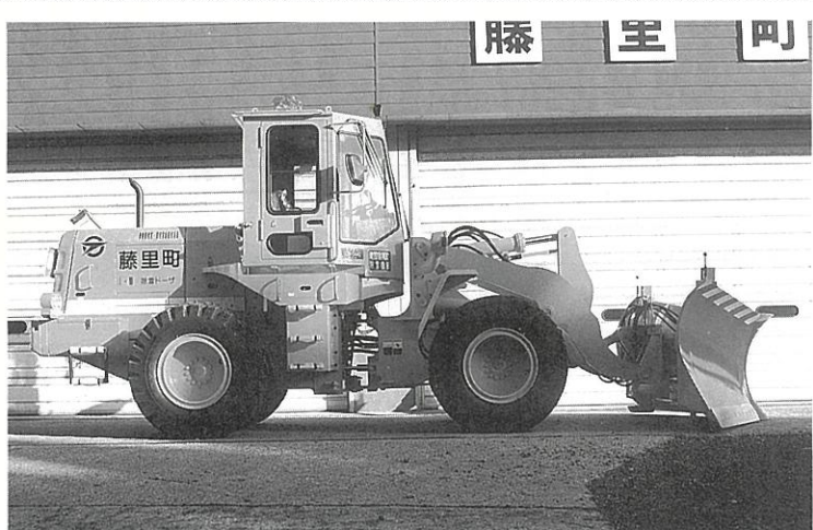
新しく購入した除雪ドーザ(65Z A-K) 全長8.6メートル 全幅2.4メートル 全高3.4メートル
